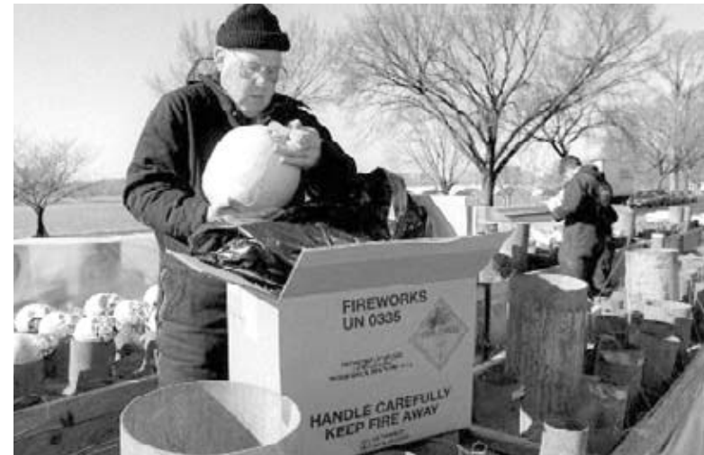
Preparando un cartucho de 25,4cm para cargar el mortero
