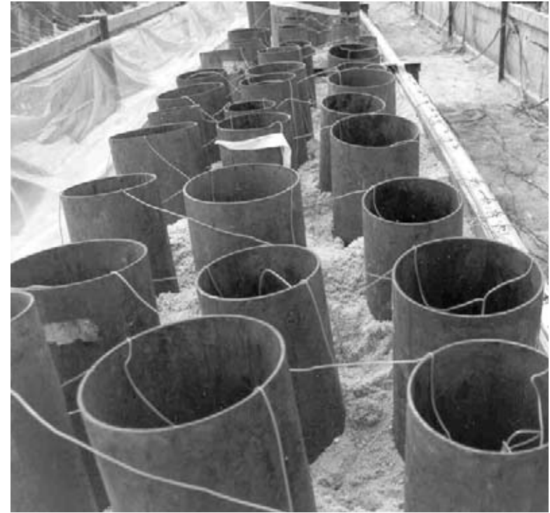
Morteros cargados con cartuchos y alambrados
